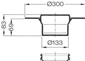
**Aufsatzelement mit Muffe**
